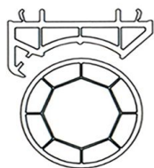
پروفیل گرد و اتصال پنج حفره
